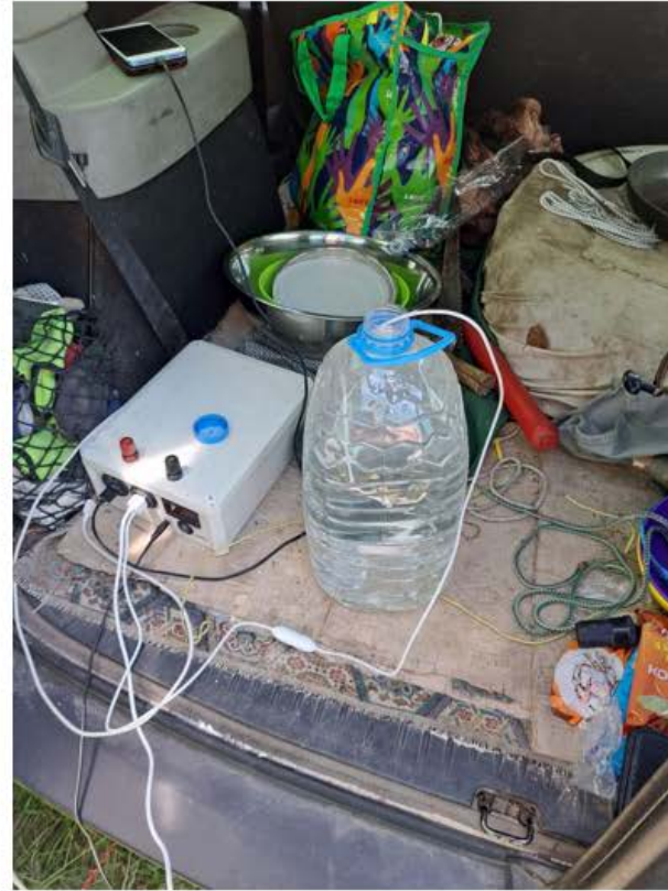
Рисунок 6.11. А та В – використання озонатора від сонячної батареї; С – використання озонатора від портативного зовнішнього акумулятора.
