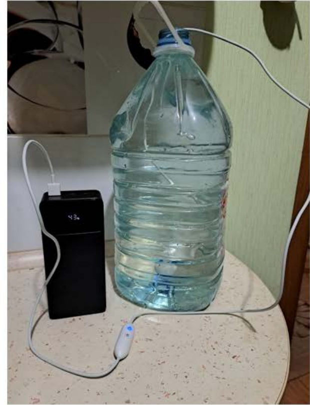
Рисунок 6.11. А та В – використання озонатора від сонячної батареї; С – використання озонатора від портативного зовнішнього акумулятора.
