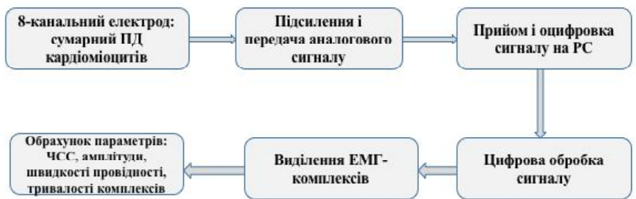
Рис. 1. Блок-схема електрофізіологічного комплексу для реєстрації сумарного потенціалу дії кардіоміоцитів.
