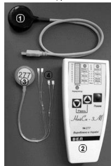
Рис. 1. Нейростимулятор "НейСи-3М" (ВЭЛ, Киев, Украина). Внешняя часть: 1 - передающая антенна, 2 - блок генератора импульсов (совмещён с пультом управления); Имплантируемая часть: 3 - приёмная антенна, 4 - электроды.
