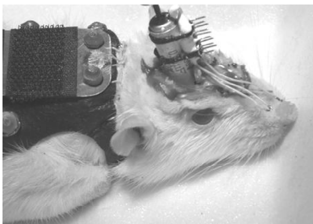
Рис. 2. Фотографія лабораторного щура на етапі імплантації мікроманіпулятора циліндричної конструкції з попередньо зафіксованим рюкзачком.
