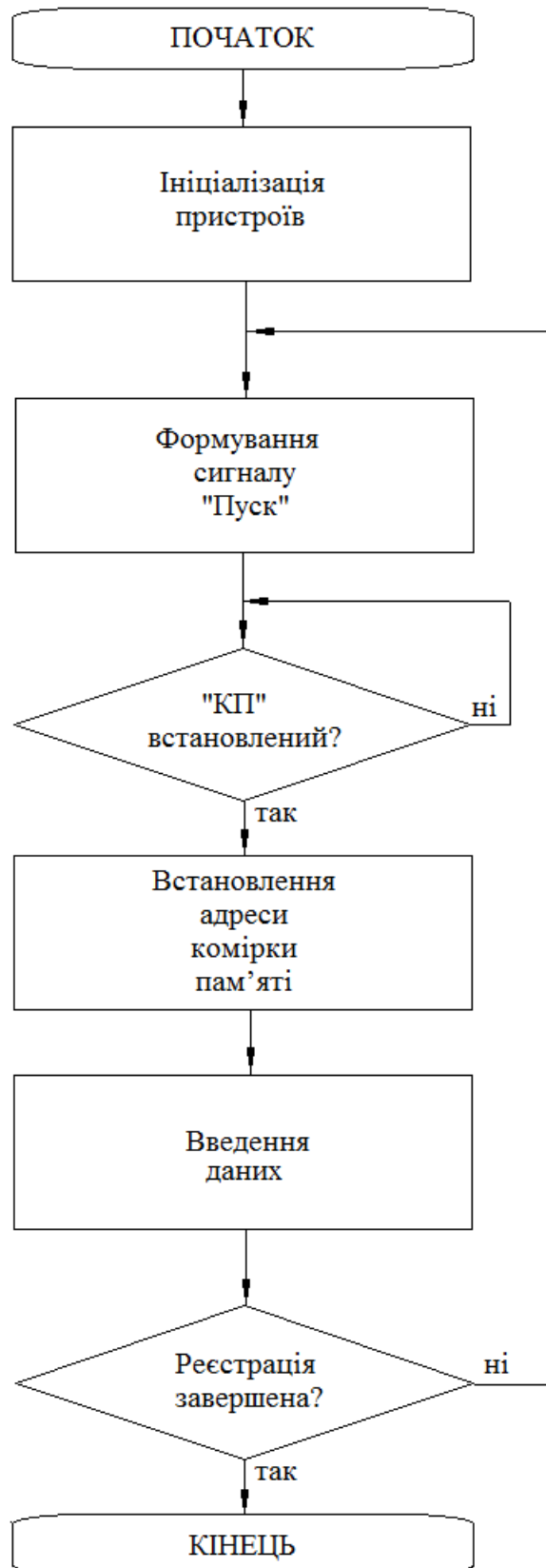
Рисунок 2.11 – Принцип роботи амплітудного вимірювального каналу на базі комп'ютерної системи для режиму програмного опитування
