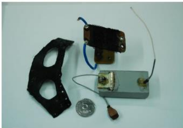
Пристрій для телеметричної передачі імпульсної активності нейронів
